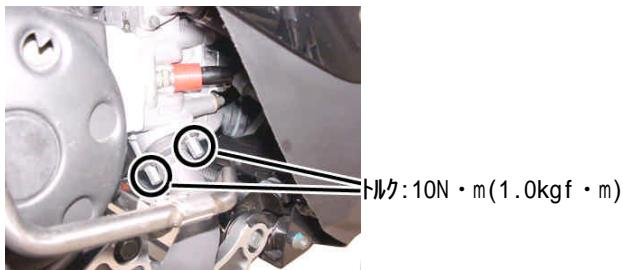
2. マフラーを固定している3箇所のボルトを取り外し、マフラーを取り外します。
