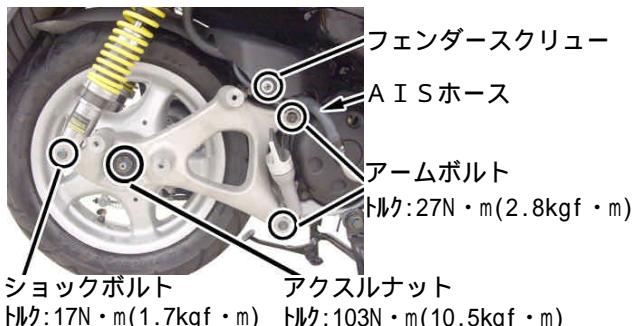
4. リヤアームを外します。A I S ブラケットのボルトを取り外し、A I Sを取り外します。
