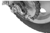
キット内のブレンワッシャ、スプリングワッシャ、アジャストナットを取り付けます。アジャストナットが緩まない様、しっかりと締め付けて下さい。
