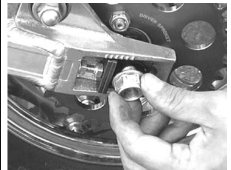
チェーンアジャスター取り付け方向図
