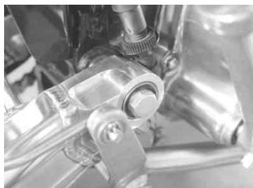
ショックアブソーバーを正立に取り付け、規定トルクで締め付けます。
