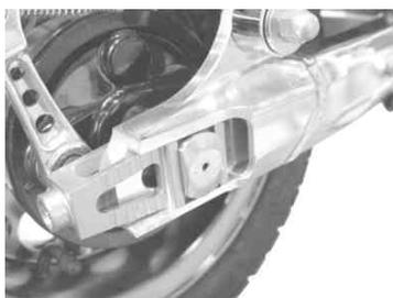
リンク数の多いチェーンを取り付けて、スプロケットに合わせチェーンをチェーンカッターでカットして取り付けます。
