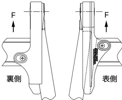
チェーンスライダージェスターには方向性があります。逆に取り付けるとチェーンラインがずれます(約6mm)ので図を確認し確実に取り付けして下さい。
