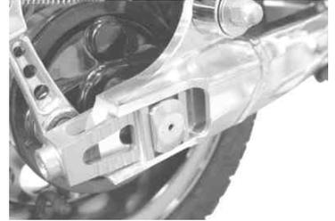
リンク数の多いチェーンを取り付けて、スプロケットに合わせチェーンをチェーンカッターでカットして取り付けます。
