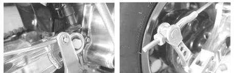
各部の締め付けトルク、及び調整範囲をもう一度確認し、付着した汚れを拭き取ります。
