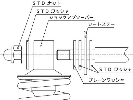
ピボットナットを規定トルクで締め付けます。
