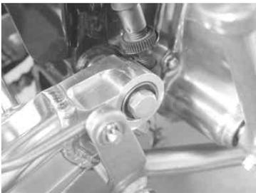
ショックアブソーバー(330mm)を正立に取り付け、規定トルクで締め付けます。
