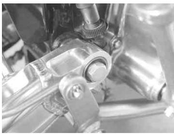
ショックアブソーバーを正立に取り付け、規定トルクで締め付けます。
