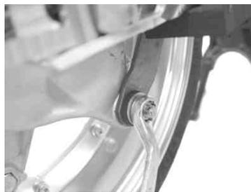
スイングアームに取り付けたブレーキトルクリンク部のフランジロックナットを規定トルクまで締め付けます。
