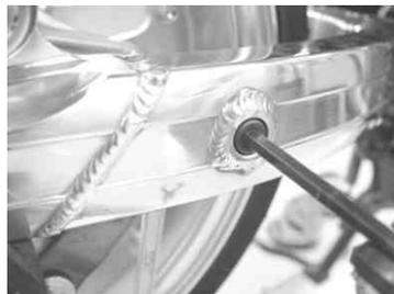
取り外したブレーキペダルをノーマル取り付け時と同様に取り付け、ブレーキペダルスプリング、ストップスイッチスプリングを取り付け、キット内の割りピン3×25を取り付けます。
