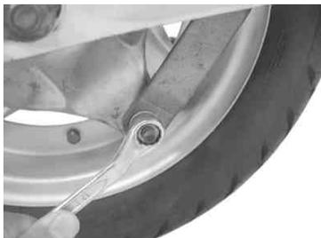
リアアクスルナットを外し、アクスルシャフトを抜き取り、リアホイールを取り外します。リアショックアブソーバーを取り外します。リアフォークピボットナットを外し、ピボットシャフトを抜き取り、リアフォークをフレームから取り外します。ドライブチェーンのクリップを外し、ドライブチェーンを取り外します。
