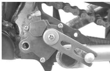
サイドスタンドカバーを取り付け、ボルトを指定トルクで締め付けます。
