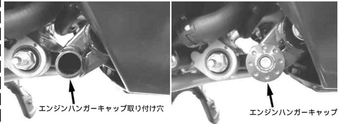
3. スクリューを締め込み固定します。締め付けはしっかりと固定される程度に、具合を見ながら少しずつ締め付けて下さい。
