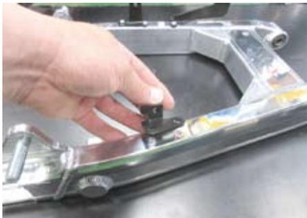
○⑩チェーンケースステアー 1、⑪チェーンケースステアー 2COMP. のピン部を①スイングアーム ASSY. の穴に差し込み⑫ボタンヘッドソケットスクリュー 5X15 を用いて取り付けます。
