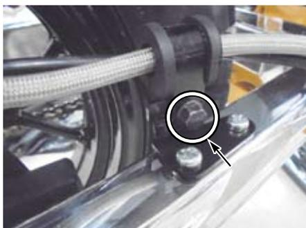
○⑩チェーンケースステア 1 及び⑪チェーンケースステア 2COMP. にチェーンケースを取り付け、パンスクリューを締め付けます。
