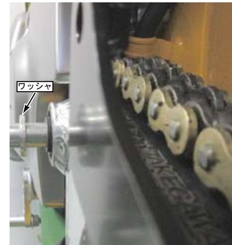
○右側に、ワッシャ、R. ステップホルダ、スイングアームピボットナット、R. ステップホルダマウントボルトを取り付けます。
