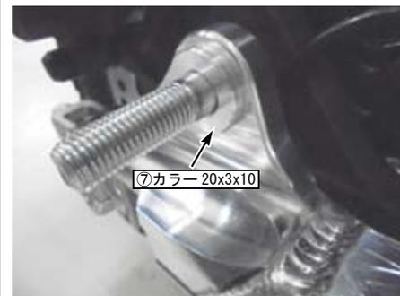
○スイングアーム ASSY. のアクスル部にリアショックを取り付け、リアクッションロアMountナット、ワッシャを取り付け、規定トルクまで締め付けます。
