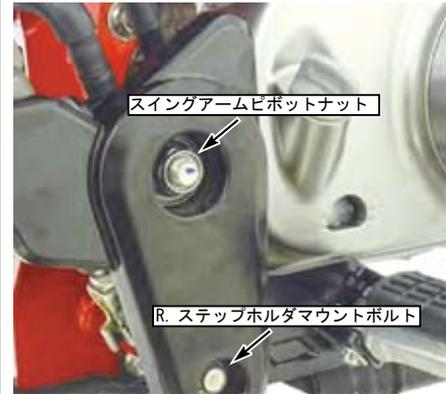
○各ボルト、ナットを規定トルクまで締め付けます。
