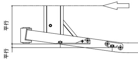
○①スイングアーム ASSY. に③チェーンスライダ、④チェーンスライダワッシャを取り付け、⑤パンスクリュー 5x12 を取り付け締め付けます。
