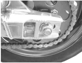
チェーンアジャスター取り付け方向図
