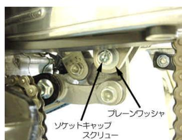
○取り外しと逆手順で、下記の部品を取り付け、R - ステップをフレームに取り付けます。
