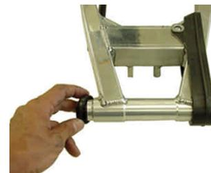
○スウィングアームピボットボルト転動部にグリースを塗布し、スウィングアームをフレームにセットします。
