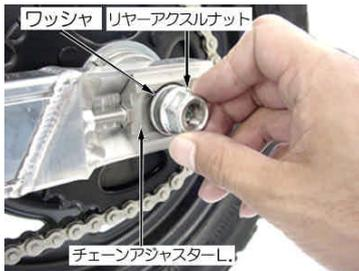
○スウィングアームホルダー部のアジャスターボルトを回してドライブチェーンの遊びを調整します。
