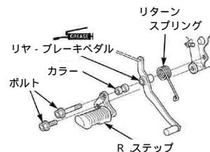
○R・ステップを取り付けているボルトを規定トルクで締め付けます。
