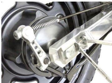
○ブレーキロッドにスプリングを取り付け、ブレーキアームにジョイントピンを取り付け、ブレーキロッドに接続します。
