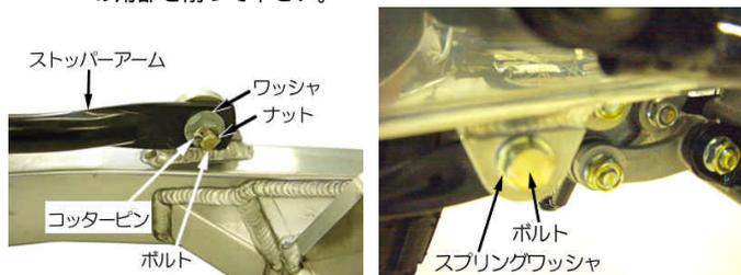
○リヤ - ブレーキストッパアームナットを規定トルクで締め付けます。
