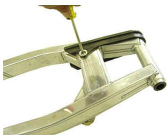
○ピボットブッシュ摺動部に、グリースを塗布し、ピボットカラーを取り付けます。
