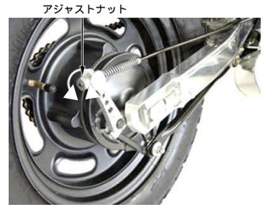
○ブレーキストッパーアームボルトをブレーキパネルの穴に確実に取り付け、下記の部品を取り外しと逆手順で、取り付け、ブレーキストッパーアームをブレーキパネルに接続します。
