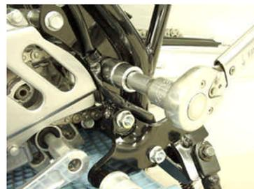
○リヤ - クッションロアマウントボルトを左側から差込み、クッションアームナットを用いてリヤ - ショックとクッションアームを接続し、KIT 内のソケットキャップスクリュー、ブレーンワッシャを左側から差込み、リヤ - クッションロアマウントナットを用いてスウィングアームとクッションアームを接続し、それぞれ、規定トルクで締め付けます。
