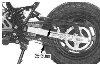
○アジャスターボルトを保持し、ロックナットを締め付けロックします。
