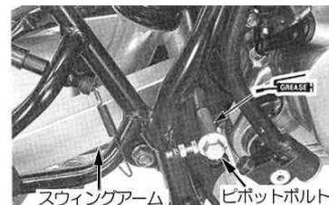
○スウィングアームピボットナットを取り付け、規定トルクで締め付けます。
