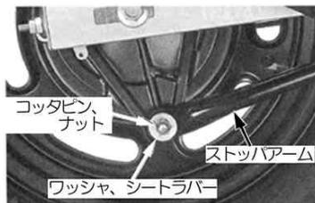
○下記の部品を取り外し、ブレーキアームからブレーキロッドの接続を外します。
