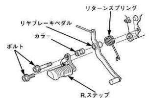
○ブレーキペダルストッパーボルトロックナットを緩め、ブレーキペダルストッパーボルトを締め込み、スウィングアームピボットボルト取り外し時のクリアランスを確保します。
