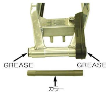
○スウィングアームピボットダストシールのリップ部にグリースを塗布し、アルミスウィングアームに取り付けます。
