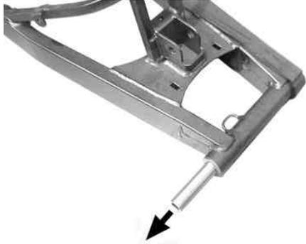
2. ピボットカラーに、傷や錆び等の異常が無いかを点検し、問題なければピボットカラーにグリスを塗布し、スイングアーム Assy. のピボット部に差し込みます。
