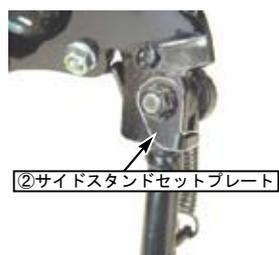
○各部のボルト、ナットの緩みが無いか確認し、再度規定トルクにて増し締めを行います。
