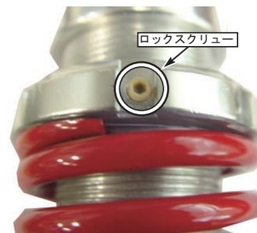
5. 硬さの調整が完了すればロックスクリューを締め付け固定します。
