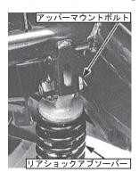
3. キットのリアショックアブソーバーを取り付け、アッパーマウントボルト、ロアマウントボルトを取り付け、 各ボルトを確実に締め付けます。
