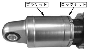
○左右にリアショックアブソーバーを取り付け、ナットを締め付けます。
