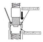
・スプリングシート、フォークスプリングを フォークチューブから取り外します。 0 リングをスプリングシートから取り外します。
