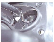
・フォークキャップを取り外します。油圧プレスを使用してスプリングシートを押し込み、ストッパーリングをフォークチューブから取り外します。
