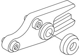
キャリパーを付属のソケットキャップスクリューでキャリパーブラケットに取り付け、規定トルクで締め付ける。
