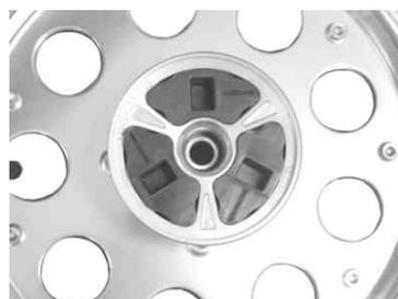
リテーナーCOMP.にドリブンスプロケットをフランジUナットを使用し、規定トルクで締め付けます。(12V専用、最小28丁)
