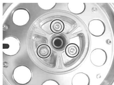
ダンパーハブにダンパーを取り付け奥まで押し込みます。
