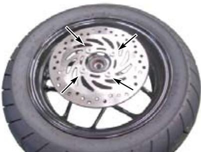
5. レーザーマーキングがある面を上に向けてフローティングディスクローターをホイールに取り付け、ブレーキディスクソケットボルトを規定トルクで締め付ける。
