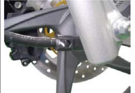
8. 各部の締め付けを確認しブレーキの作動を確認する。
