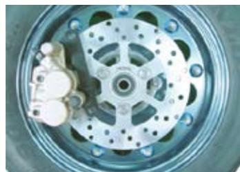
6. キャリパーをソケットキャップスクリュー (8x12) でキャリパーブラケットに取り付け、締め付けます。
