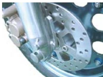
8. ホイールとハブを固定するフランジソケットキャップスクリューを締め付けます。
