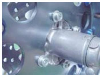
9. フロントホイールハブにフロントホイールハブカラーとスピードメーターギアボックスをセットし、フロントフォークに取り付けアクスルナットを規定トルクで締め付けます。
