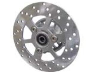
4. 10インチアルミホイールに、フロントホイールハブをフランジキャップスクリューで仮締めします。
