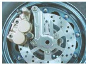
7. キャリパーブラケットの凹みをフロントフォークの凸部に合わせ、付属のアクスルシャフトを進行方向に向かって右側からフロントフォーク、キャリパーブラケット、フロントホイールASSY.、メーターギア、カラー、フロントフォークの順になるように右側から通し仮締めします。
