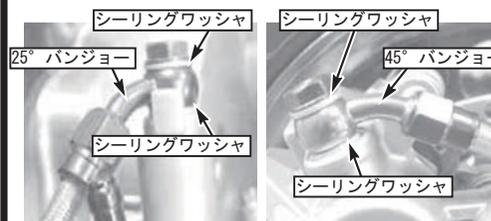
○マスターシリンダー及びリアキャリパーに25°及び45°バンジョーを配置し、シーリングワッシャで挟む様、バンジョーボルトで仮締めます。
