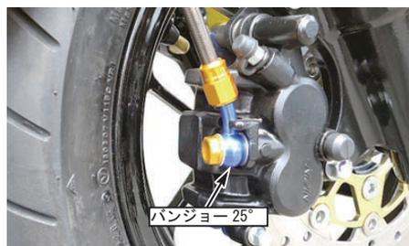
4. ブレーキホースを各クランプに通して各バンジョーに取り付けます。バンジョーボルト、ブレーキホースのフィッティングを指定トルクで締め付けます。
