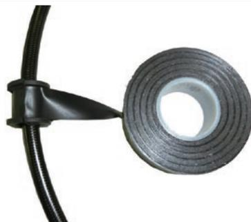
ブレーキホースのグロメット部をクランプに取り付けます。クランプからグロメットが外れてしまう場合は、クランプを曲げてグロメットが外れないようにします。
