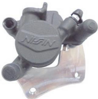
○ブレーキキャリパーにスプリング、ブレーキパットをセットし、パットボルトを取り付け規定トルクまで締め付け、プラグボルトを取り付けます。
