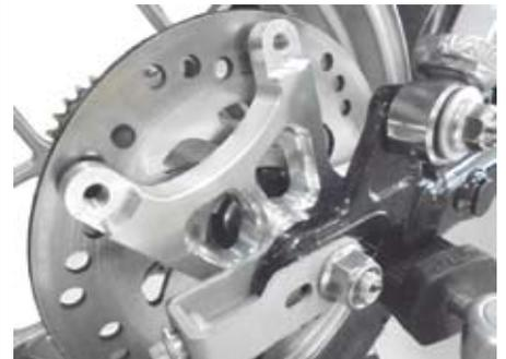
・ブレーキパッド間にブレーキディスクを合わせ、①キャリアブラケット COMP. にブレーキキャリアパーを②フランジソケットキャップスクリュー 8x20 を用いて取り付け、規定トルクまで締め付けます。
