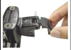
○①フロントマスターシリンダー ASSY. をハン ドルに⑦フランジ6角ボルトで仮締めして、 レバーの位置決めをします。
