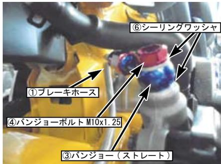
・ブレーキキャリパーに⑥シーリングワッシャ 10mm、②バンジョー（サイド 45°）、⑥シーリングワッシャ 10mm、⑤バンジョーボルト M10x1.0 を用いて仮締めし、ブレーキホースを接続し仮締めします。
