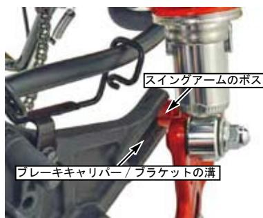
○アクスルナットを規定トルクで締め付けます。
