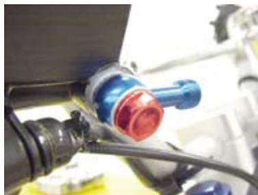
○フロントキャリパー側は⑧バンジョー (45°) を①フロントブレーキマスターシリンダー ASSY. (11mm) と同様の方法で取り付けます。
