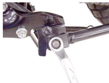
9. L. ステップブラケットをフレームに固定している2本のボルトを緩め、L. ステップブラケットを取り外します。
