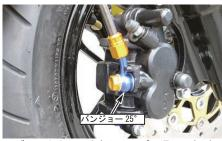
ブレーキホースを各クランプに通して各バン ジョーに取り付けます。バンジョーボルト ブレーキホースのフィッティングを指定トル クで締め付けます。
