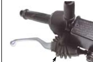
○取り付けが完了すればレバー位置の調整を行って下さい。(1が最も近く6が最も遠くなります。)
