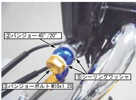
○①ブレーキホース 830mm を車両に取り回し、ブレーキキャリパー側の②バンジョー (45° /20°) に取り付け仮締めします。
