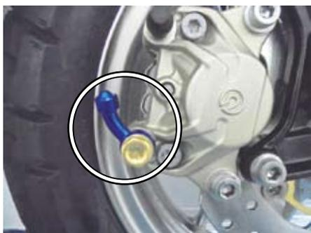
○マスターシリンダー側に⑤シーリングワッシャ 10mm、②バンジョー (45° /20°)、⑤シーリングワッシャ 10mm、③バンジョーボルト M10x1.25 の順に取り付け、①ブレーキホース 830mm を②バンジョー (45° /20°) に取り付け仮締めします。
