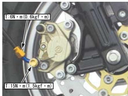
○純正ブレーキホースクランプ部のグロメットにカッター等で割を入れ、接着剤を剥がして取り外し、①ブレーキホースに取り付け、外れないようビニールテープを巻き純正同様にホースをクランプします。
