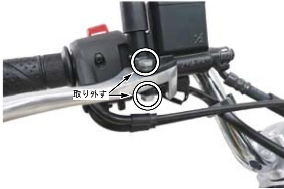
○ブレーキレバーのピストン部とレバーピボットボルト部にシリコングリスを塗布します。
