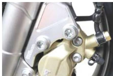
○ブレーキのエア抜き要領の指示に従い、エア抜きを行います。
