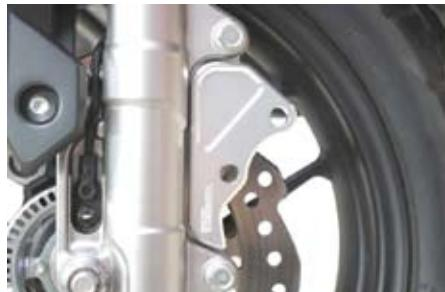
○ 4POT キャリパーを②フランジソケットキャップスクリュー 10x25 を使用し、①キャリパーブラケットに取り付け、規定トルクにて締め付けます。
