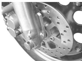
10. ホイールとハブを固定するフランジキャップスクリューを締め付けます。
