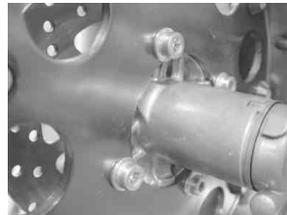
11. フロントホイールハブにサイドカラーとスピードメーターギアボックスをセットし、フロントフォークに取り付けアクスルナットを指定トルクで締め付けます。
