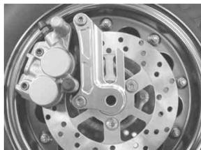
9. キャリパーブラケットの凹みをフロントフォークの凸部に合わせ、付属のアクスルシャフトを進行方向に向かって右側からフロントフォーク、キャリパーブラケット、フロントホイールASSY、メーターギア、カラー、フロントフォークの順になるように右側から通し仮締めします。
