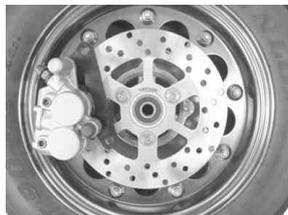
8. キャリパーをソケットキャップスクリュー(8×12)でキャリパーブラケットに取り付け、締め付けます。
