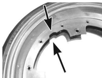
6. ホイールの合わせ面が L と R で段差の無い位置になるよう位置を調整し、フランジソケットキャップスクリュー 6 x 1.6 及びフランジUナット M6 を仮止めします。
