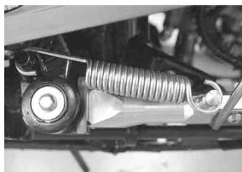
11. スタンドボルトの長さを調整し、スタンドナットを仮止めします。スタンドボルトは下図の長さの範囲で調整を行って下さい。スタンドボルトを範囲以上に出すと脱落や破損の恐れがあります。
