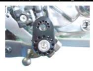
〇ピン位置関係図を参考に①ステップバー COMP. を②ステップブラケット Aに取り付け、⑥ソケットキャップスクリュー8x18で締め付けます。
