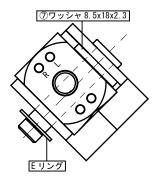
☆ KSR(タイモデル)の車両は車体個体差が大きく、ステップブラケット部 に⑦ワッシャ 8.5x18x2.3が入らない場合、キット内の⑧プレーンワッシャ 8mm を使用して取り付けて下さい。
