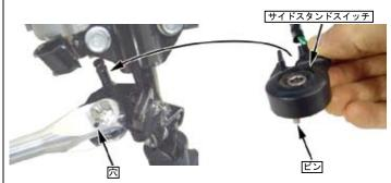
○サイドスタンドスイッチをノーマルのスペシャルボルトにて④ピボット ボルトに取り付けます。
