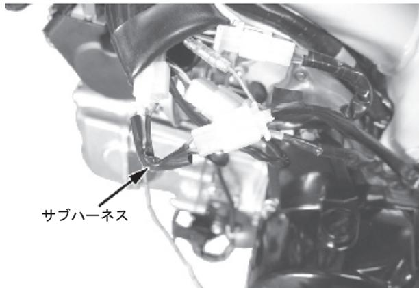
5. ECUユニットサブハーネスComp.の丸アース端子を、スターターモーター下側スクリューの純正アースコードと共締めします。
