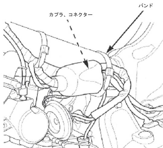
4. 3P白色カプラの接続を外し、ECUユニットサブハーネスComp.を割り込ませるように接続します。
