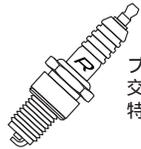
プラグはレジスタータイプを、ハイテンションコードはノーマルを必ず使用してください。交換しますとノイズによりセンサーが正常に温度を検知出来ません。特にプラグとセンサーが近い場合、悪影響は大きくなります。
