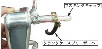
6. キャッチタンク COMP. をブレンワッシャーとソケットキャップスクリュー 8x25 で、ノーマルマフラスターを固定していたネジ穴に取り付け、ソケットキャップスクリューを指定トルクで締め付けます。
