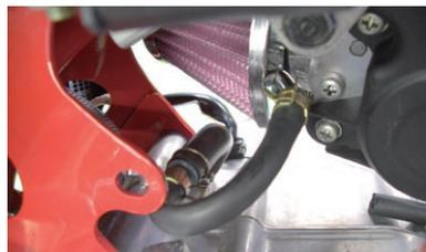
10. クラッチカバー用ブリーザーキャップとブレードホース (12x17) を取り回し、ブリーザーに合わせて切断し、ブリーザーユニオンに接続しホースクランプを取り付けます。
