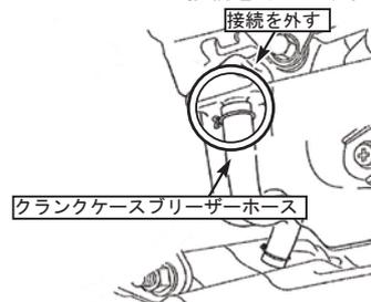
8. 純正クランクケースブリーザーホースの太くなっている部分をカットしキット内の異型ホースコネクタを取り付け、ホースクランプ φ 11.6 を取り付けます。
