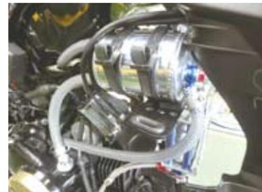
11. シリンダーヘッドからホースを取り出す場合、ブレードホースφ8を適当な長さに切断し、オイルキャッチタンク（左側、バンジョー30°）とシリンダーヘッドをホースクランプφ13.1で接続します。
