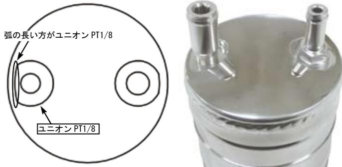
5. ユニオン PT1/8 を下にした状態で、左にアルミシーリングワッシャ、バンジョー、シーリングワッシャ、バンジョーボルトの順で仮留めします。シリンダーヘッドから取り出しを行わない場合は、右側の取り付け穴にだけオイルプラグボルトを取り付けて下さい。
