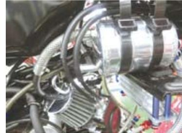
9. ブレードホースφ12を適当な長さに切断し、オイルキャッチタンク（ユニオン PT1/8）とプリーザーキャップ COMP. をホースクランプφ15.5で接続します。
