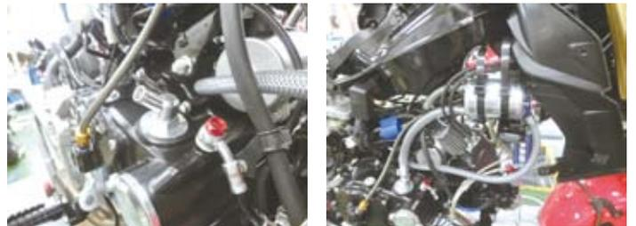
10. ブレードホースφ8を適当な長さに切断し、オイルキャッチタンク（右側、バンジョー30°）とクランクケースをホースクランプφ13.1で接続します。
