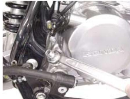
○クラッチカバー用⑨ブレードホース 12x500 を⑦ブリーザーキャップに差し込み、⑫ホースクランプφ 15.5 にて固定します。
