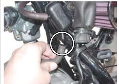
○①オイルキャッチタンク COMP. のクラッチカバーブリーザー用ユニオンに⑨ブレードホース 12x500、ブローバイ排出用ユニオンに⑩ブレードホース 8x1000、クランクケースブリーザー用ユニオンに⑪チューブ 5x500 を差し込みます。⑨ブレードホース 12x500 には⑫ホースクランプφ 15.5、⑩ブレードホース 8x1000 には⑬ホースクランプφ 13.1、⑪チューブ 5x500 には⑭ホースクランプφ 9.5 を使用し、各ホースを固定して下さい。
