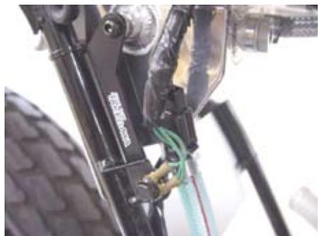
○③ L. ステアをフレーム L 側のエアクリナーケース固定用ネジ穴の外側に⑮ボタンヘッドソケットスクリュー 6x10 にて仮止めし、③ L. ステアと①オイルキャッチタンク COMP. を⑮ボタンヘッドソケットスクリュー 6x10 にて仮止めします。
