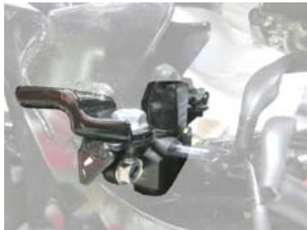
○車体右側には②オイルキャッチタンクステーをフレームとバンクアングルセンサーの間に挟み、ノーマルボルトで仮締めし、車体左側には⑦プレーンワッシャをフレームとバンクアングルセンサーの間に挟み、ノーマルボルトで仮締めします。②オイルキャッチタンクステーの取り付け角度が定まったら、ノーマルボルトを規定トルクにて締め付けます。
