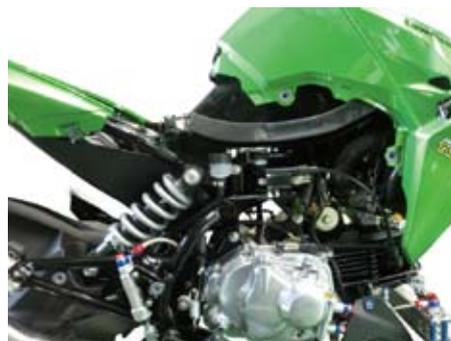
○クイックリベットとスクリュー及びワッシャを取り外し、ミドルカウリングを外します。
