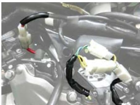
○メインハーネスが車両のフレームに、2ヶ所クリップで留まっているので、フレームからメインハーネスを外します。外れたら、メインハーネスからクリップを外します。
