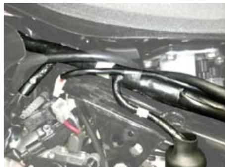
○⑫ボタンヘッドソケットスクリュー 6x15 と⑬フランジナット 6mm を使用して、メインハーネスがクリップで留まっていた2ヶ所の穴を使用し、②オイルキャッチタンクステーをメインフレームに取り付けます。
