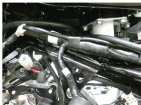
○メインハーネスをメインフレーム側に移動させます。この時、出来るだけメインハーネスがメインフレームと燃料タンクの間に入るようにします。
