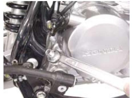
■フレームに①キャッチタンク COMP. を固定します。
